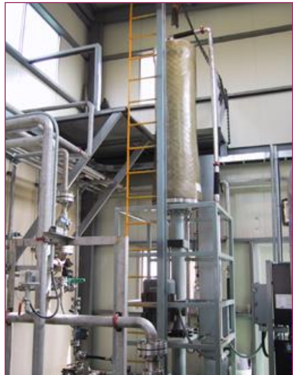
Sistema VSEP installato per il Trattamento Letame Suino in Korea
